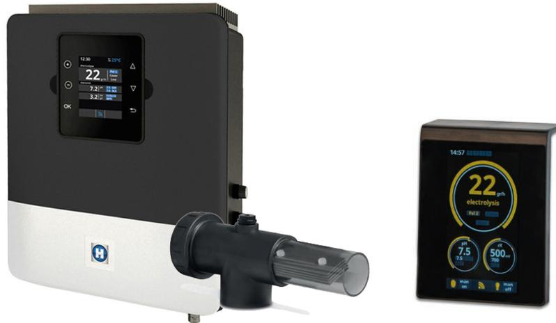
Inspirado en la naturaleza, los sistemas de electrólisis salina generan cloro a partir de la sal común disuelta en el agua. La sal necesaria para su funcionamiento debe ser añadida una sola vez a la piscina en una concentración de 4-6 g/l. (6 veces inferior a la del agua del mar) y similar a un suero fisiológico o a la lágrima humana.
